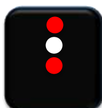
Nave con manovrabilità limitata (ferma)
